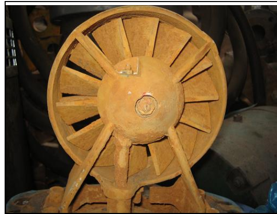
شکل (۳): فرسایش ساختار یک کنتور [۵]
